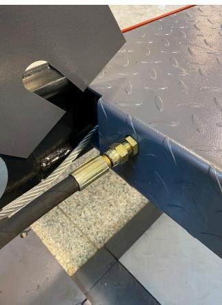
25. Montera hydraulslangen i båda ändar.
