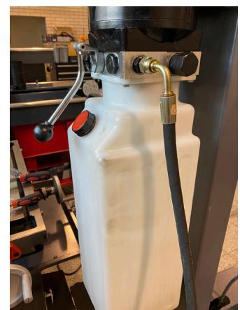
23. Lyft upp manöverskåpet och hydraulikenheten och montera fast det på pelaren.
