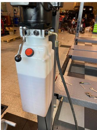
26. Fyll på med hydraulolja så det står upp till 2-3 cm under locket
