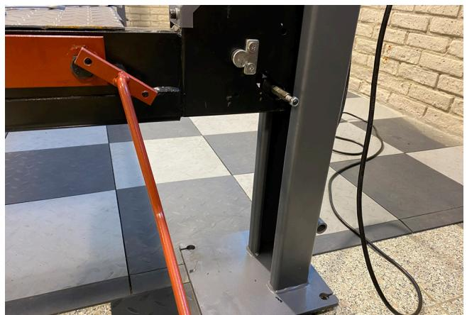
29. Kontrollera så positionen på länkagejärnet är samma i båda ändar innan du monterar dem.
